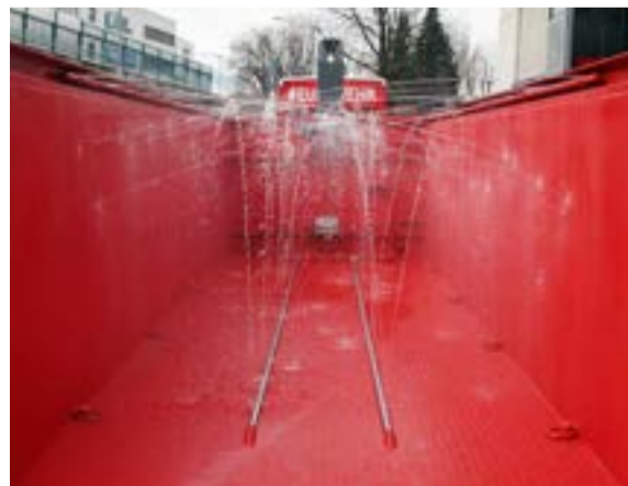
Die Düsen am Boden kühlen die in der Bodenplatte sitzende Batterie.
