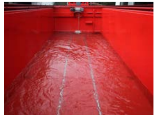
Der Container kann auch geflutet werden, er ist wasserdicht. Ca. 21.000 Liter Wasser haben Platz. Die Seilwinde dient zum Hineinziehen von Fahrzeugen.
