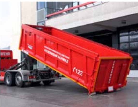
Der Abrollbehälter wird mit einem Wechselladerfahrzeug zur Einsatzstelle gebracht.
